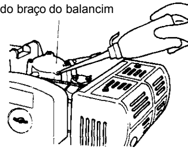
Figura 6-7 Coloque óleo para auxiliar na partida
